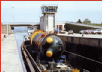
arrivée de la cuve du réacteur de la tranche 1 (350 tonnes), après 5.000 km de voyage par voie d'eau.
